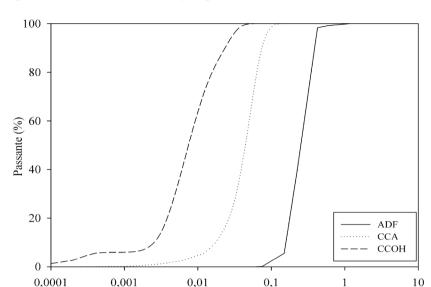
Figura 1 - Curva de distribuição granulométrica da ADF, CCOH e CCA
