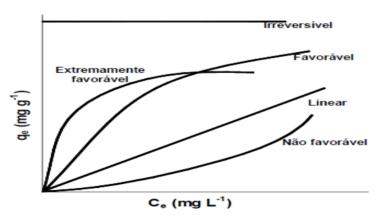
Figura 1 - Tipos de isotermas de adsorção
